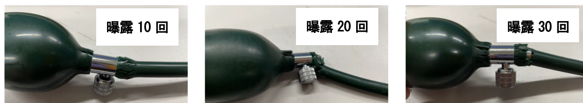
図 1 オゾン曝露後の血圧計の状態
